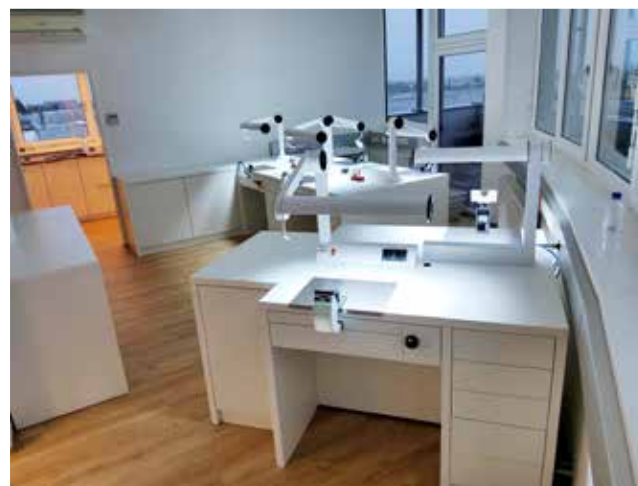
Одноместный стол ТМ 1, рабочая поверхность из ультрапаса. Рабочее место для одного техника с встроенным пылесосом, проводкой газа и воздуха.
